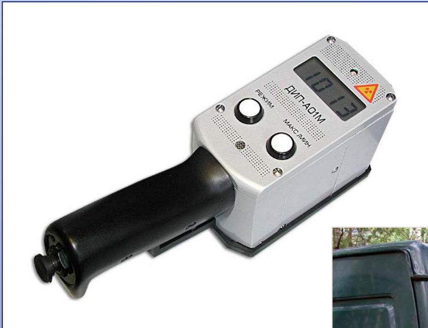
Обнаружение контрабандных предметов (оружие, взрывчатка, наркотики, валюта и т.д.), находящихся за панелями, перегородками или внутри закрытых объемов.
